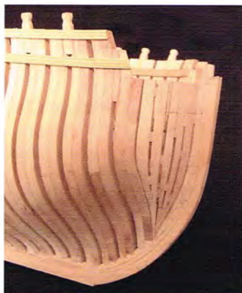
Les allonges d'écubiers sont ne pas appuyées sur un massif, elles aboutissent "en pointe" sur l'étrave. Elles comportent une maille qui s'affine en partie basse. On intercale des garnitures dans ces mailles pour les cheviller et pour y percer les écubiers. Les deux premières allonges associées aux languettes constituent les apôtres qui servent de maintien latéral au mât de beaupré.
