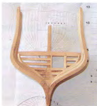
L'arcasse vue de l'intérieur, on retrouve les dispositions détaillées sur la photo précédente. Le sabord de charge présente une grande ouverture qui intercepte deux barres d'écusson. En partie basse, on observe très bien les oreillers et les éléments des deux premières barres d'écusson.
