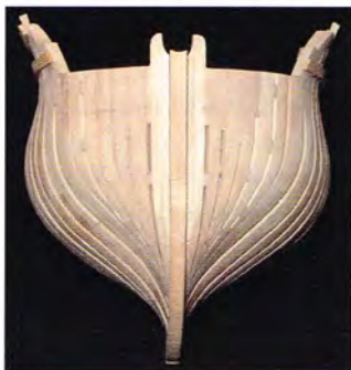
Les allonges d'écubiers sont ne pas appuyées sur un massif, elles aboutissent "en pointe" sur l'étrave. Elles comportent une maille qui s'affine en partie basse. On intercale des garnitures dans ces mailles pour les cheviller et pour y percer les écubiers. Les deux premières allonges associées aux languettes constituent les apôtres qui servent de maintien latéral au mât de beaupré.
