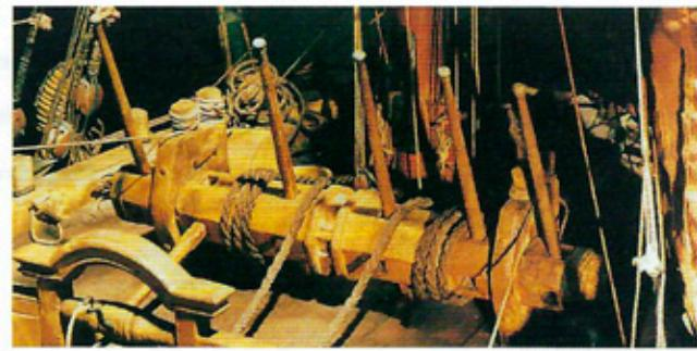
▲ L'imposant gréideau placé sur le gaillard d'avant ne occupe presque toute la largeur. Constitué d'un rouleau suspendu par deux flasques consistant en deux parties, il est employé pour le levage des ancrages et, à l'occasion, pour certaines manœuvres du gréement. Manipulé grâce à des barres dont plusieurs sont parvenues, c'est un instrument très courant dans la petite marine du commerce où le
