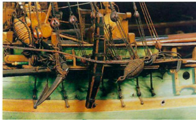
▲ Les ancres sont appuyées sur les portes hubans de misaine. Elles y sont retenues par des bresses amarrées aux appontoirs. Les courbatures des portes hubans sont en forme d'arc boutant. Cette disposition permet de ranger des espars sous ces arcs-boutants. On trouve ici un aviron et une vergue de triste. Les anglo utilisent souvent des arcs-boutants aux portes-hubans contrairement à la France où ce type de renfort est quasiment ignoré.
